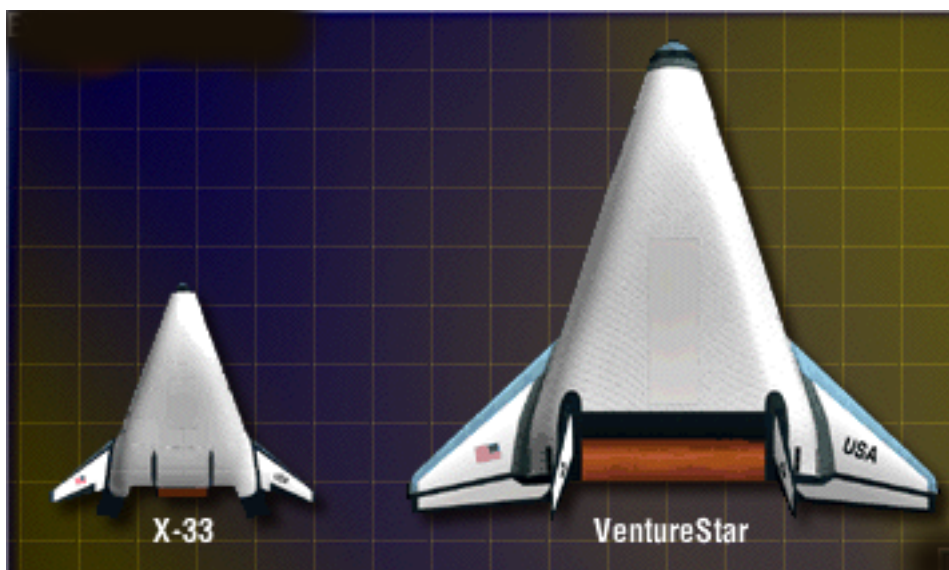
Obrázek 1: Konstrukce X-33 a VentureStar ve srovnání podle animátorů Marshall Space Flight Center.
