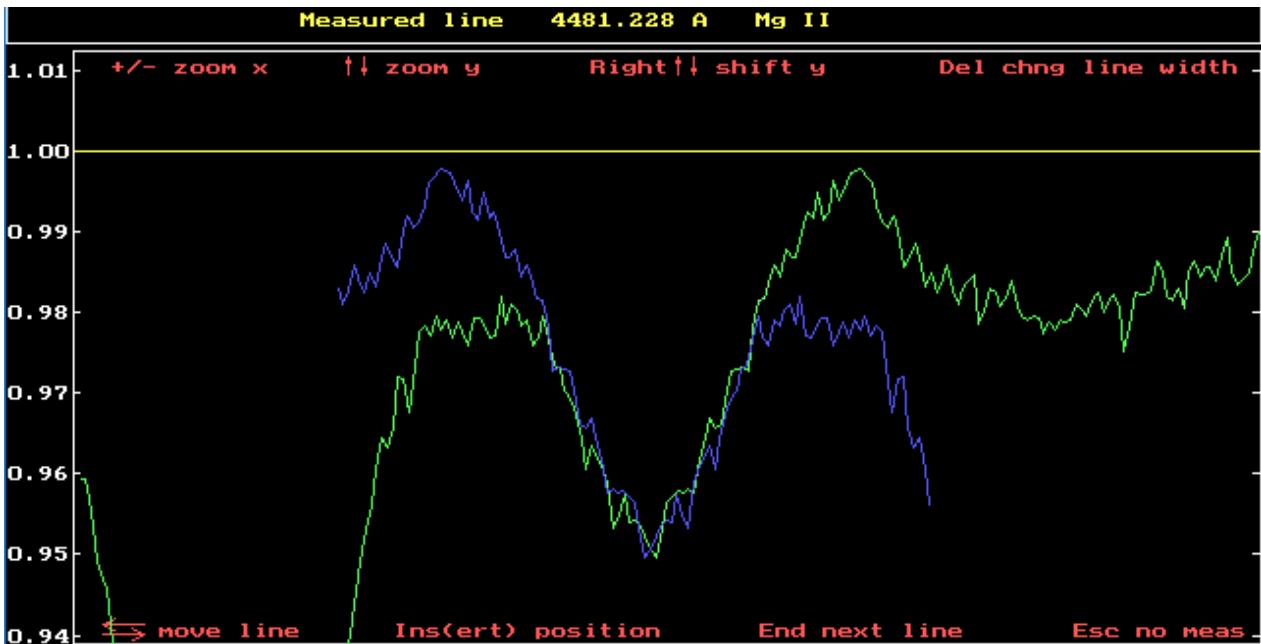
Obrázek 2.11: Spektrální čára Mg II - seřízení s kalibračním spektrem
