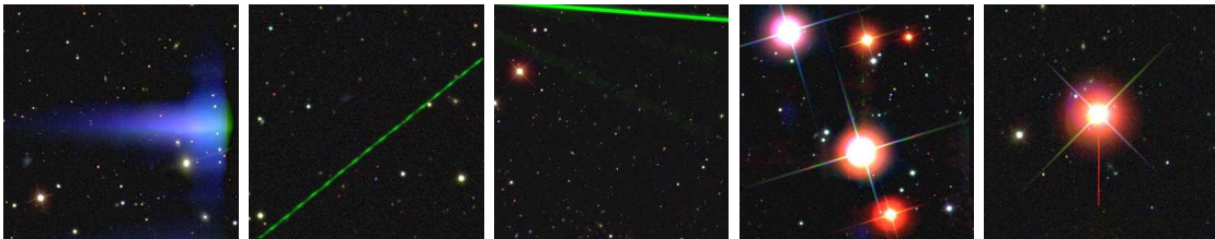
Obr. 12: Duchové, odlesky a identifikované létající objekty na snímcích SDSS. První obrázek ukazuje fotografii zorného pole s jasnou hvězdou v blízkém okolí. Její světlo se odrazí od tubusu dalekohledu a dopadne na čip. Konstrukce dalekohledu byla sice navržena tak, aby takové odrazy eliminovala, ale jak vidíme, velmi silný zdroj světla dokáže své. Druhý obrázek zachycuje satelit na nízké orbitě. Jasnost satelitu kolísá v důsledku jeho rotace. Na třetím obrázku máme štěstí a vidíme právě prolétávající jasný meteor. Čtvrtý obrázek předvádí difrakční kříže hvězd, vzniklé na konstrukci dalekohledu. Šestý obrázek by měl být nejnápadnější světelným halem okolo jasné hvězdy. Pokud totiž jeden pixel CCD kamery značně osvětlíme, přeplní se záporným nábojem. Náboje se mohou přemístit i do okolních pixelů.
