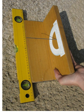
Obr. 2 — Jednoduché stínové úhломěrné zařízení pro měření úhlu \alpha . Úhломěr přiložený ke stěně je vodorovný a svislá tyčka na něj vrhá stín. Na tomto obrázku je úhel \alpha = -41^{\circ} .
