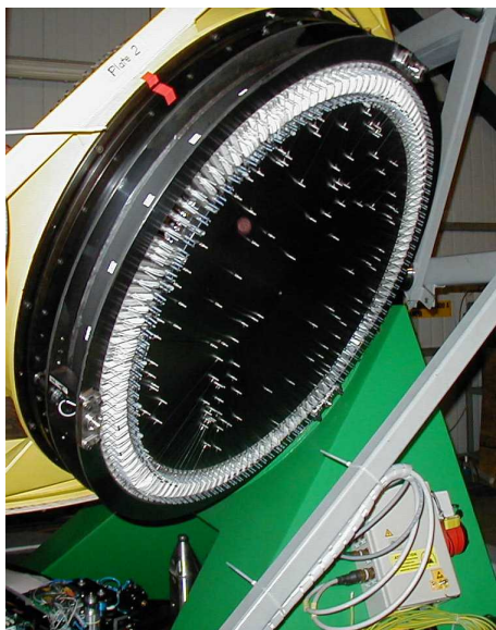
Obrázek 5: Polohovač optických vláken v přístroji FLAMES (Pasquini a spol. 2002). Na magnetické desce vidíme zakončení optických vláken (v podobě výstupků) rozmístěná tak, aby odpovídala polohám hvězd v ohniskové rovině, přičemž vlákna samotná směřují k okraji a posléze do štěrbin spektrografu. Převzato z http://www.eso.org/sci/facilities/paranal/instruments/flames/inst/Giraffe.html .
