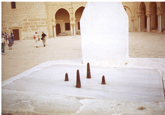
Obr. 19 — Vodorovné sluneční hodiny v mešitě v Kairouanu v Tunisku. Jedná se o poměrně složité hodiny vybavené čtyřmi kolnými ukazateli (označme je podle světových stran S, J, V, Z). Stín severního gnómonu ukazuje na obvodu číselníku PMŠČ, uvnitř kalendária (sestavujícího ze dvou hyperbol a jedné přímky) babylonský a italský čas a na křivce označené N_{\text{Asr}} lze číst začátek modlitby Asr (viz obr. 18). Jižní gnómon ukazuje začátek modlitby Dhor (na křivce S_{\text{dhor}} ), východní, resp. západní gnómon ukazuje čas uplynulý od úsvitu, resp. zbývající do setmění, a to na křivkách označených O_3 , O_4 , resp. E_3 , E_4 . (Zde se nemyslí východ/západ Slunce, ale začátek/konec astronomického soumraku.) V dolní části hodin je vyznačen azimut muslimského poutního města Mekky a nápis dokumentující celkovou rekonstrukci a přepočítání hodin v roce 1289 Hidžry (tj. rok 1837 podle řehořského kalendáře). V současnosti jsou již sluneční hodiny značně poškozeny povětrnostními vlivy — číselník je nezřetelný a gnómony jsou zkráceny asi o 0,5 cm. (a) Foto Katarína Brožová (2001). Obrázky (b), (c) převzaty z [66].
