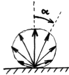
Obr. 4 — Lambertův zákon rozptylu, znázorněný jako rozptylový diagram ve tvaru koule přiléhající k povrchu.
